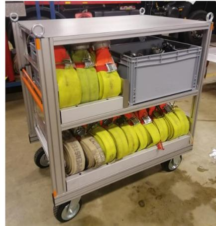
TS, Schläuche und Wasserführende Armaturen wurden vom KLF-A auf die neu angeschafften Rollcontainer aufgebaut, diese sind ab sofort im neuen VF-A gelagert.
